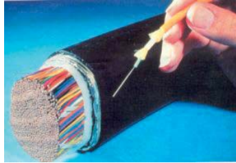
Abbildung 31: Substitution durch technische Entwicklung: Um gleiche Bandbreiten zu erzielen, muss ein Kupferkabel ca. 100-mal dicker als eine einzelne Glasfaser sein (Quelle: FOS FiberOptics Stockreiter).
