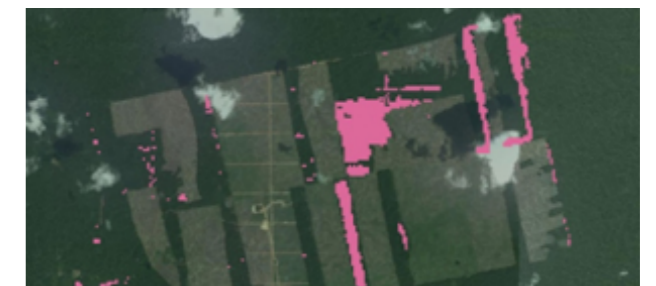
Abbildung 17: Mit frei verfügbaren Daten kann der Wald wirksam überwacht werden. Durch die verbesserte Auflösung von Landsat-Satellitendaten im 30x30 m-Raster bleiben selbst kleine lineare Strukturen wie Wege nicht mehr unentdeckt. Die Abbildung zeigt dasselbe Gebiet einmal mit MODIS-Daten (250x250 m) und einmal mit Landsat-Satellitendaten (30x30 m). Quelle: Popkin, 2016
