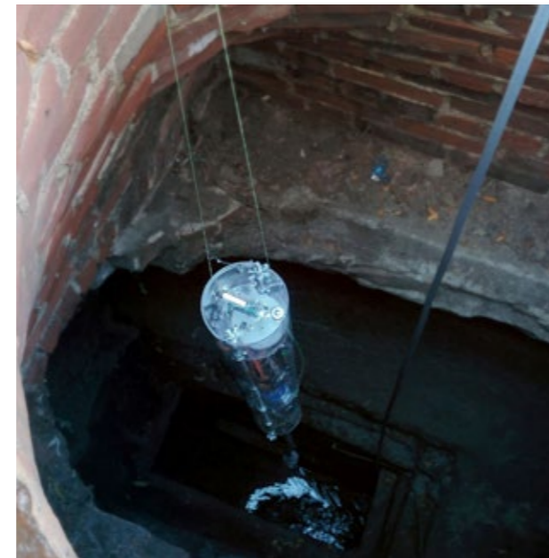
Abbildung 12: Die Prototypen „Mario“ und „Luigi“ im Einsatz. Sie sammeln Daten aus den Abwässern von ca. 4.000 Haushalten. Quelle: MIT Senseable City Lab
