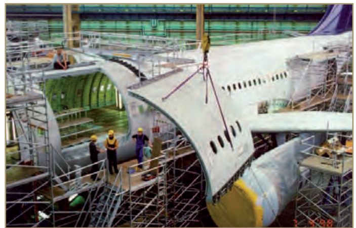
Abb. 2 Einbau eines 3,5 m breiten und 2,5 m hohen Frachttors [Quelle: EADS]
